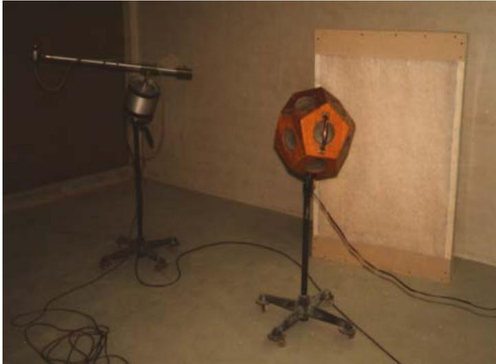
Bild 11 Mikrofon, Schallquelle, Diffusor
