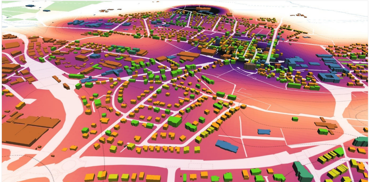
Abb. 8: Die Heatmap als analytisches Instrument zur Analyse der räumlichen Wärmebedarfsmuster
